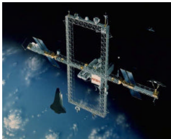
図6 宇宙ステーションに使われるトラス 宇宙開発事業団のホームページより
