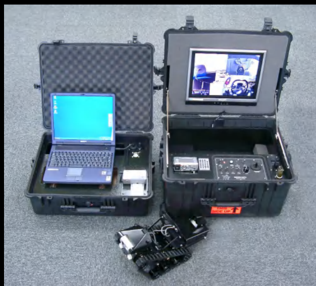
I：コントロールボックス（外観） 必要な資材は全てボックス内 に収納可能 II：カメラ操作PC & プリンター III：観察映像記録装置 IV：大型液晶モニター V：ビークルコントロールパネル
