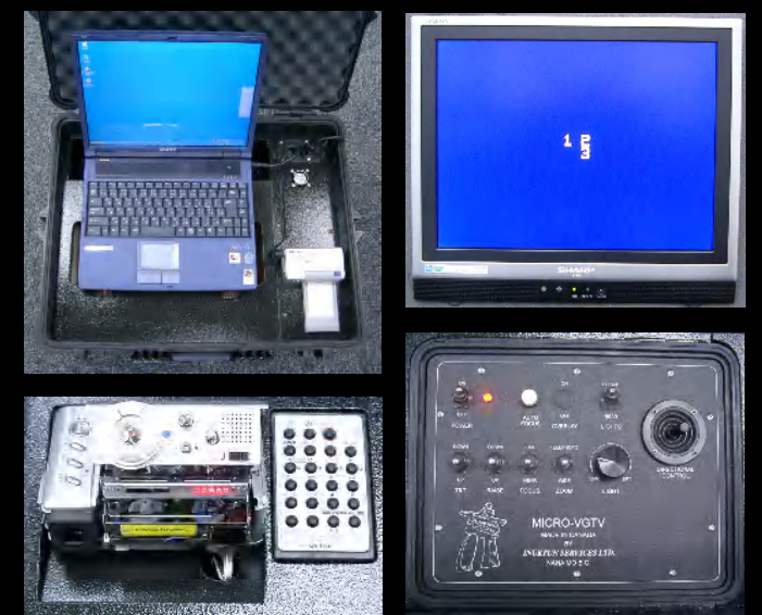
I：コントロールボックス（外観） 必要な資材は全てボックス内 に収納可能 II：カメラ操作PC & プリンター III：観察映像記録装置 IV：大型液晶モニター V：ビークルコントロールパネル
