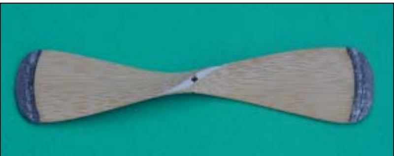
左図は鉛を貼り付けたところ
