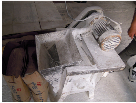
この機械でソーダ灰と 石けんの素地を混ぜて 砕きます。
