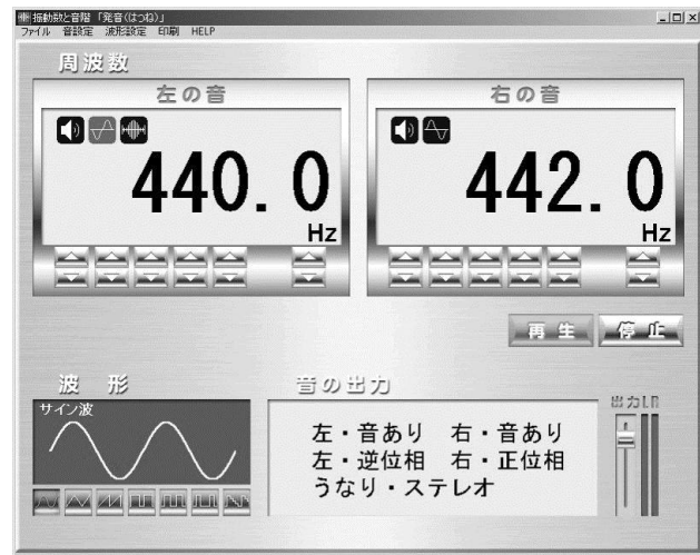
図10 うなりの実験 左右異なる振動数を出力
