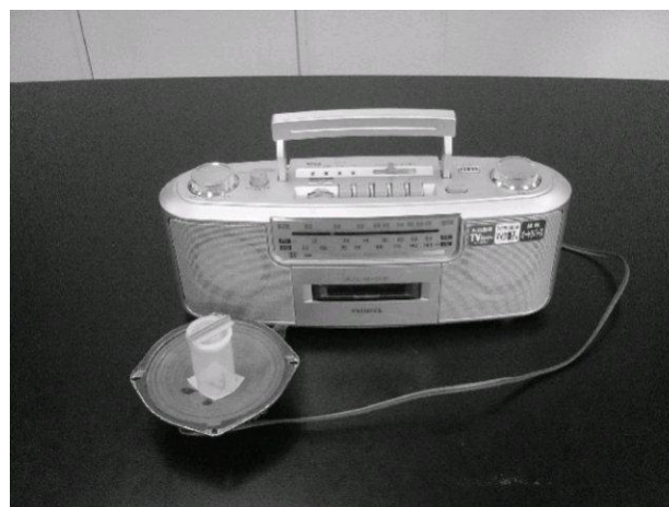
図11 ラジカセ(増幅器)と弦用振動源
